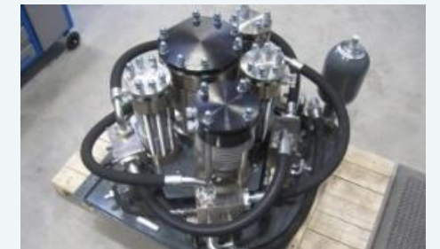
IC – Ionic Compressor (GH2)
